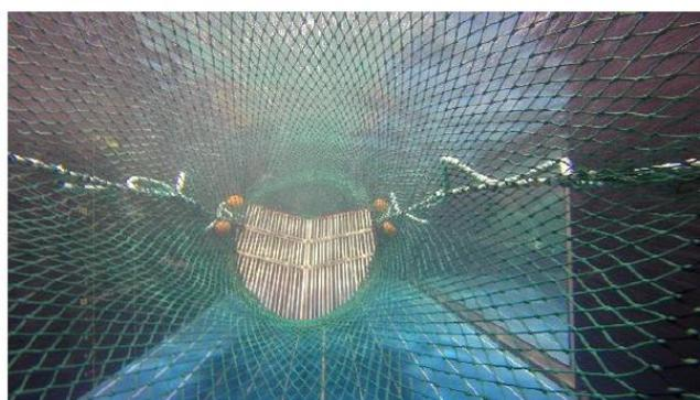
Figure 4 : Vue avant (depuis l'entrée du chalut) de la grille aluminium montée dans la rallonge (© Ifremer).
