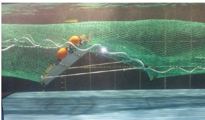
Figure 3 : Vue latérale de la grille aluminium montée dans la rallonge (© Ifremer).
