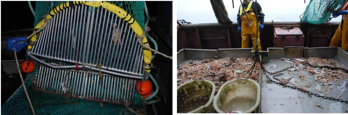
Figure 7 : Déformation de la grille et pertes de captures importantes dans le chalut sélectif.
