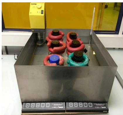
Figure 14 : Schéma et photographie du dispositif expérimental d'adsorption en réacteur bath
