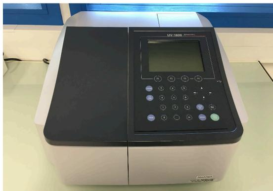
Figure 7 Photographie du spectrophotomètre UV-vis Shimadzu, UV-1800
