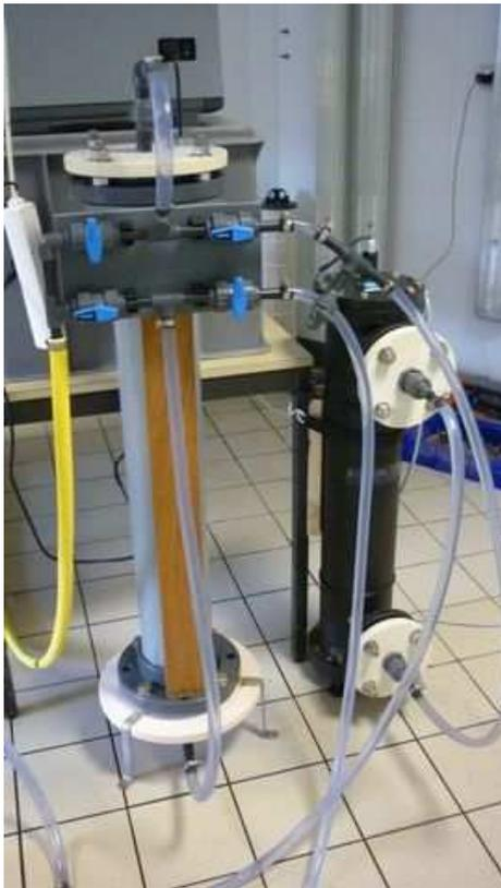
Figure 35 : Colonne d'adsorption IFREMER et réacteur UV en aval
