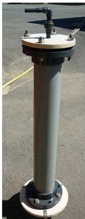
*Figure 34 : Colonne d'adsorption IFREMER*
