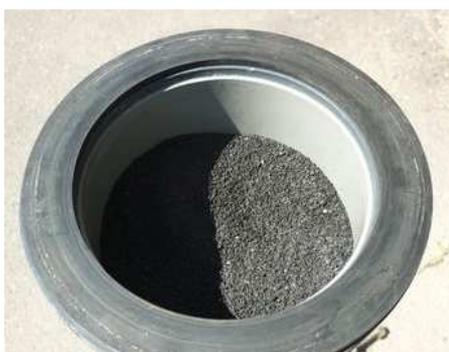
*Figure 33 : Intérieur de la colonne d'adsorption IFREMER*
