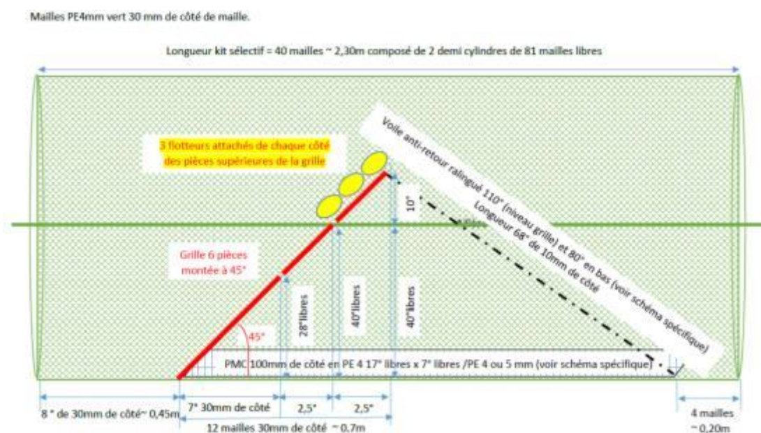
Figure 17 : Schéma du montage de la grille à langoustine : « kit grille à langoustine »
